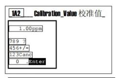
准备对探头进行第二个测量点校准。将探头插入第二瓶校准液,并按下Enter键来确认。
