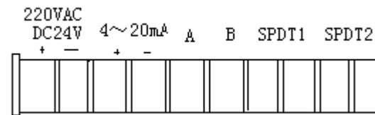
电源：220VAC 或 DC24V，订货时告知；输出信号：4~20mA；RS-485：A B；
