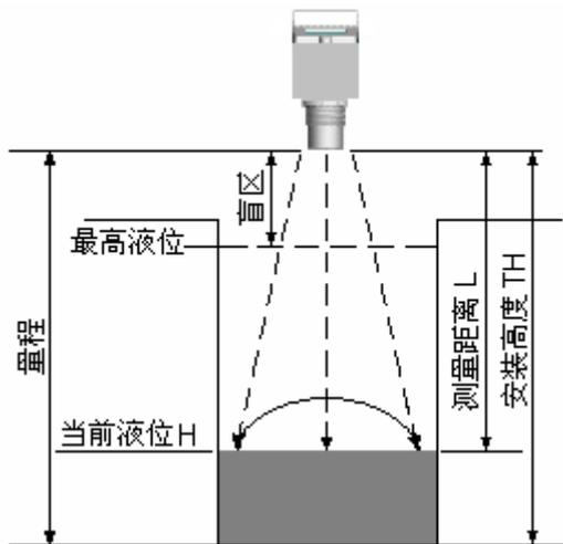
如上图所示，仪表的探头发波打到液位后反射回探头，探头接收到后计算发波到收波的时间，得到测量距离  $L$ ，仪表安装高度  $TH$  减去测量距离  $L$  将得到当前液位  $H$ 。
